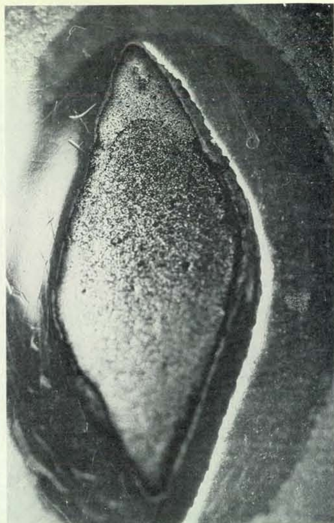
La fotografia a destra è una «sezione lucida» trasversale metallografica di un «disco da getto» con sezione a parallelogramma appiattito, ingrandita circa 15 volte. L'attacco microchimico con soluzione cloridrica al 30 per cento evidenzia la differente tessitura cristallina del margine tagliente e dei bordi induriti a martellatura (zone più chiare) rispetto a una tessitura microgranulare indisturbata e omogenea del corpo centrale (zona più scura). Qui sopra, nel dettaglio del tagliente a ingrandimento maggiore (circa 45 volte) si nota la tessitura cristallina del bronzo, deformata irregolarmente dagli effetti della martellatura. Dalle ricerche compiute su quattro esemplari risulta così che la lega bronzea era sottoposta a un processo di incrudimento meccanico lungo i margini esterni del disco allo scopo di indurirne il tagliente e aumentarne l'efficacia.
